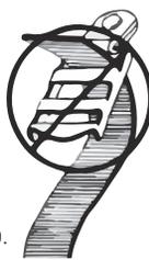
3. INSPECCIONE TODAS LAS CORREAS PARA ASEGURARSE DE QUE NO TENGAN DESGASTE O DAÑO ALGUNO.
