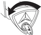
**SCHRITT 3:** DRÜCKEN SIE DEN FEDERSTIFT DER KUPPLUNG UND SETZEN SIE DEN FAHRRADSTÄNDER IN DIE KUPPLUNGS-AUFNAHME BIS DER FEDERSTIFT IN DIE KUPPLUNGS-AUFNAHME AM FAHRZEUG EINRÄSTET.
