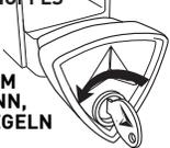
ENTGEGEN DEM UHRZEIGERSINN, UM ZU ENTRIEGELN
