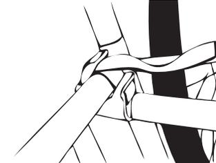
4. VERWENDEN SIE EINEN 1,80 M LANGEN GURT (NICHT IM LIEFERUMFANG ENTHALTEN), UM ALLE FAHRRÄDER ZUSAMMEN AN DEN UNTEREN HALTERUNGEN ZU SICHERN. DER GURT SOLLTE AUCH DIE FELGEN SICHERN.
