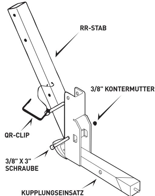
**BENÖTIGTE WERKZEUGE:** 2-9/16" SCHLÜSSEL UND 2-3/4" SCHLÜSSEL, ODER 2 ROLLABELSCHLÜSSEL
